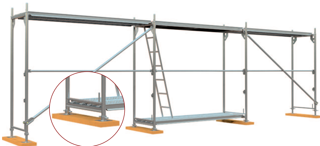
Rys. 9. Zastosowanie belek startowych i pomostów stalowych do podparcia drabiny pierwszej kondygnacji
