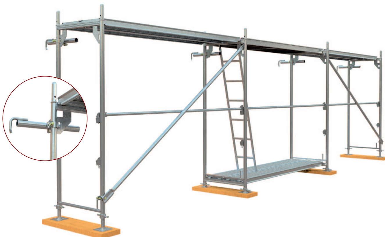
Rys. 10. Montaż łączników kotwiących pierwszej kondygnacji
