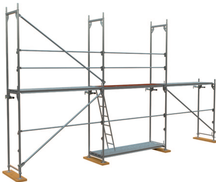
Rys. 12. Montaż stężenia ukośnego drugiej kondygnacji
