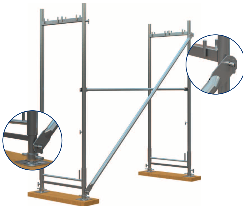
Rys. 5. Montaż stężenia ukośnego pierwszego pola
